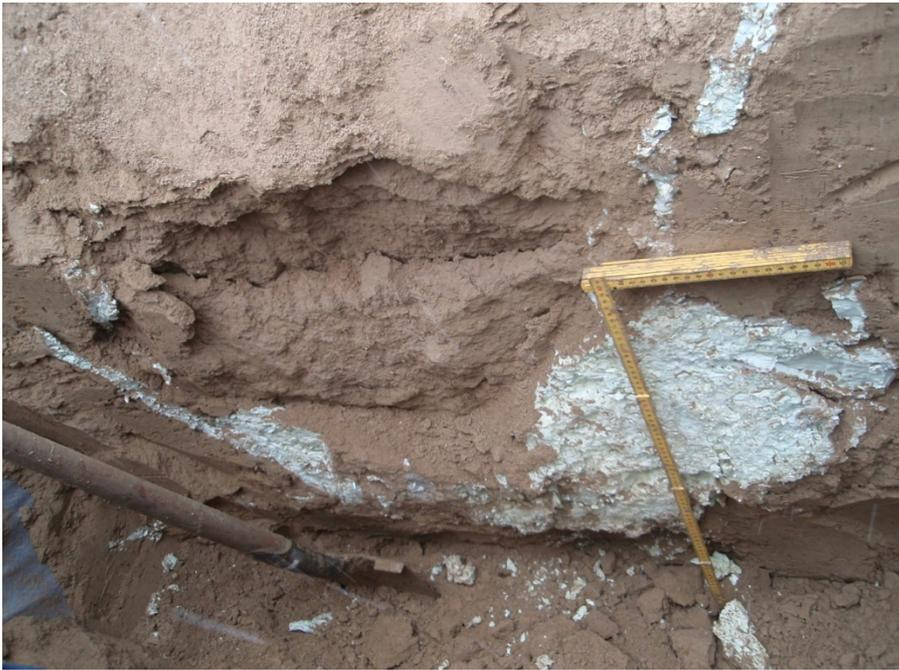
Abbildung 18, Ausbreitung des Injektionsgutes im Bereich der Injektionsstelle
