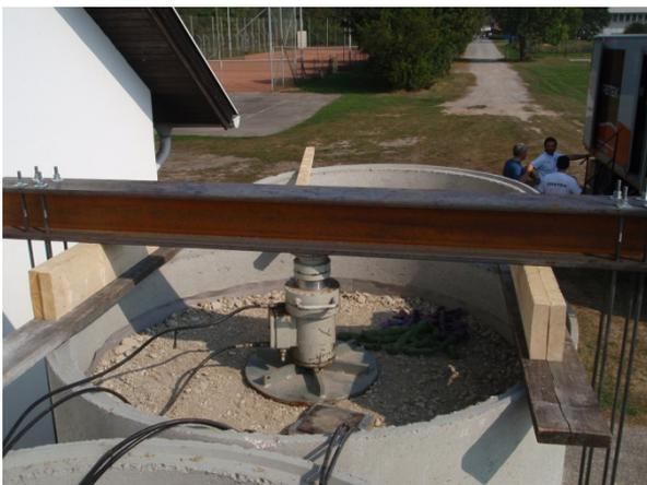
Abbildung 3 Belastungszylinder mit Widerlager
