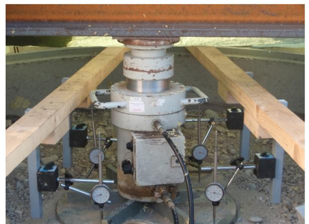
Abbildung 4, Belastungszylinder und Lastplatte mit Messuhren
